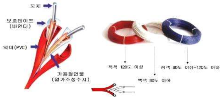
[ 그림 1-18 ] 정온식감지선형감지기의 형태 및 표시
