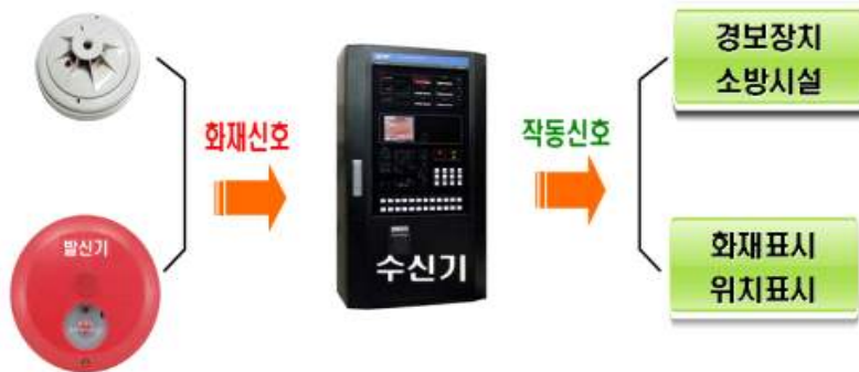
[ 그림 1-3 ] 자동화재탐지설비의 작동흐름도
