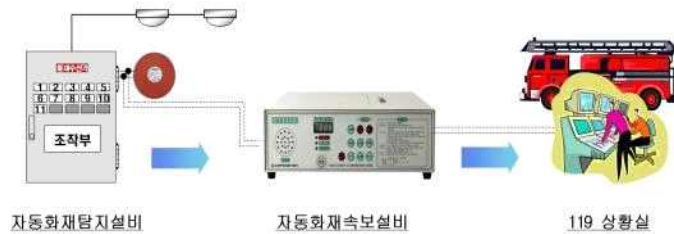
[ 그림 1-74 ] 자동화재속보설비 작동 구성도
