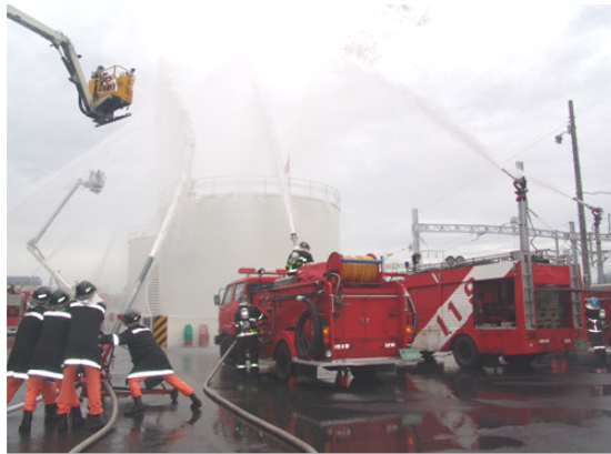
그림 5.7_무인대량방수장비는 탱크를 냉각시키는 데 사용한다.
