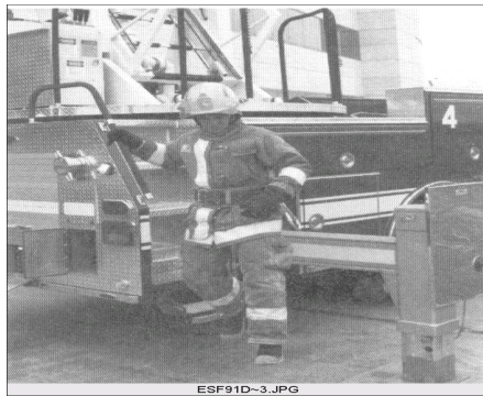
그림 5.20_만약 감전된 소방차에서 빠져 나올 필요가 있을 때는 소방대원이 소방차와 지면에 동시에 닿지 않도록 소방차로부터 뛰어나와야 한다.
